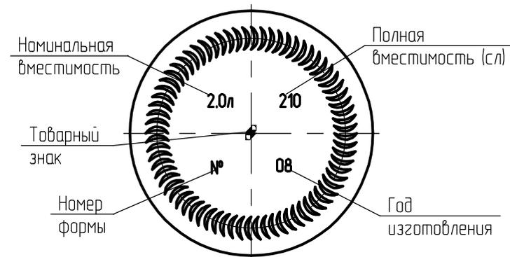
1. Контролируемые размеры:  $\phi 80.75 \pm 0.45$ ;  $\phi 129.4 \pm 2$ ;  $206.7 \pm 1.4$ ; полная вместимость  $(2100 \pm 30) \text{ см}^3$ .
