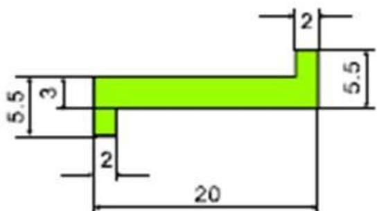
Рис.2. Ролик обратного хода
