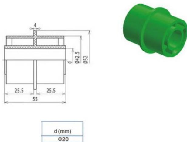
Рис.3. Профиль С (пластик+алюминий)
